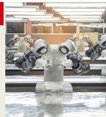
協働型双腕ロボットは、針に糸を通すなど、まるで人間が両腕で作業するような繊細な動きも実現でき、作業の幅が格段に広がる
